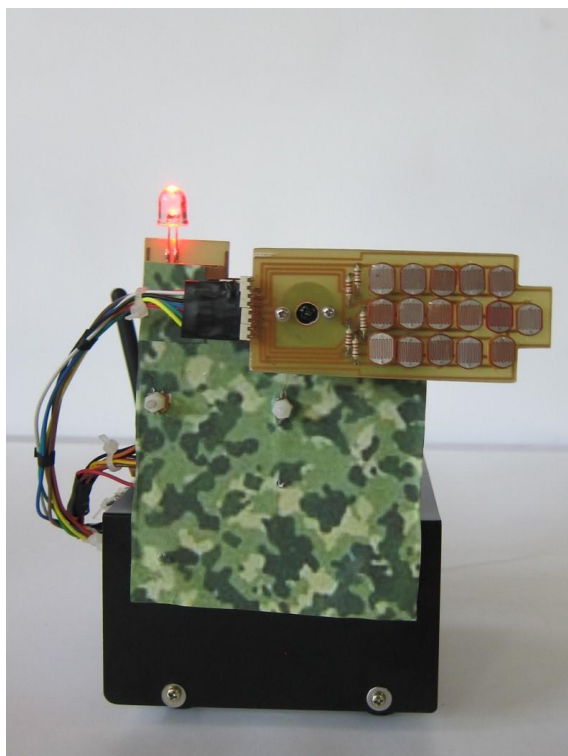
圖八：靶位被雷射光擊中後的警示反應
